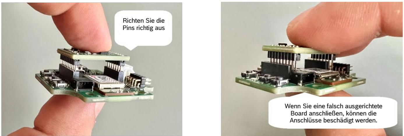
Abbildung 9: Ausrichten der Pins der Shuttle Board 3.0 Board
