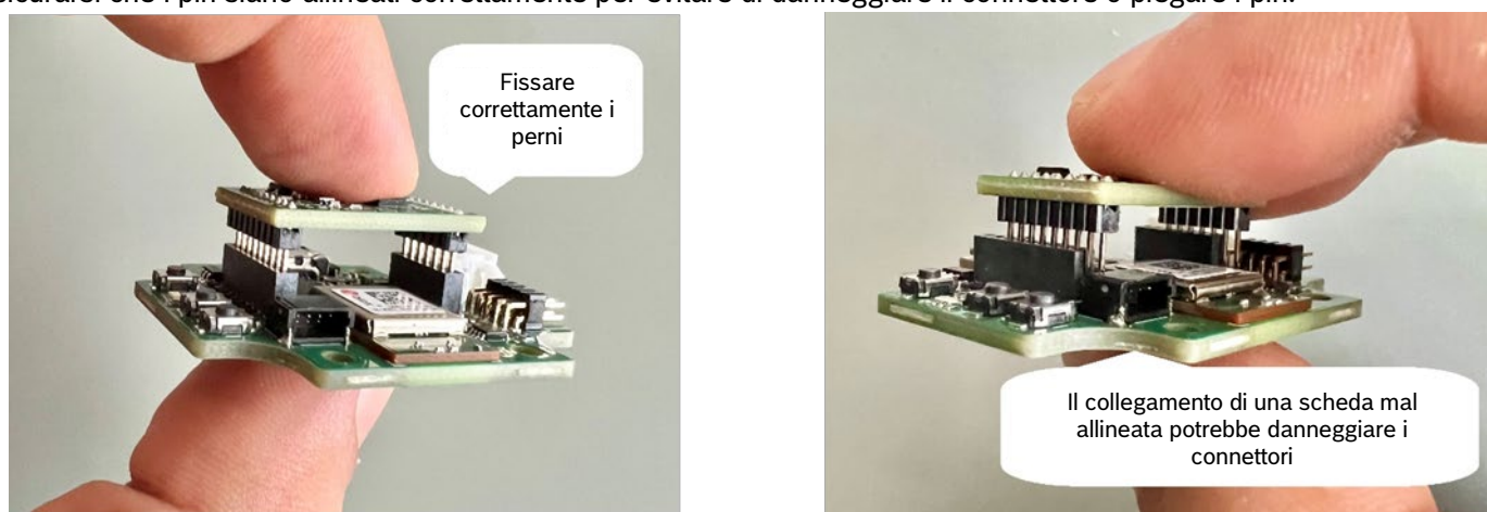
Figura 9: Allineamento dei pin della Scheda Shuttle 3.0
