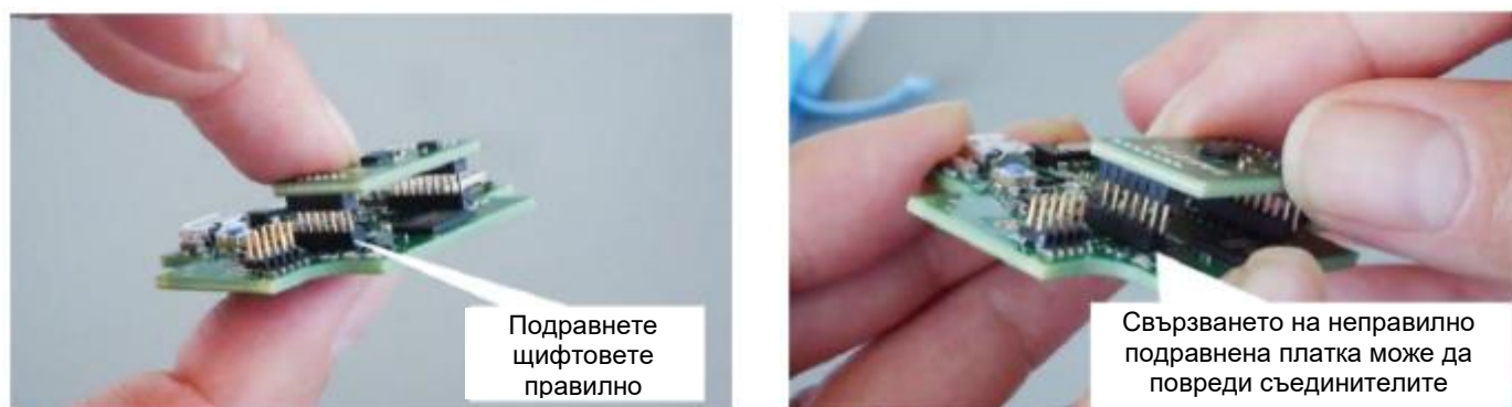
Фигура 8: Подравняване на щифтовете на Shuttle Board 3.0
