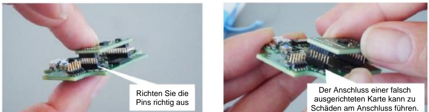
Abbildung 8: Ausrichten der Pins der Shuttle Board 3.0-Platine
