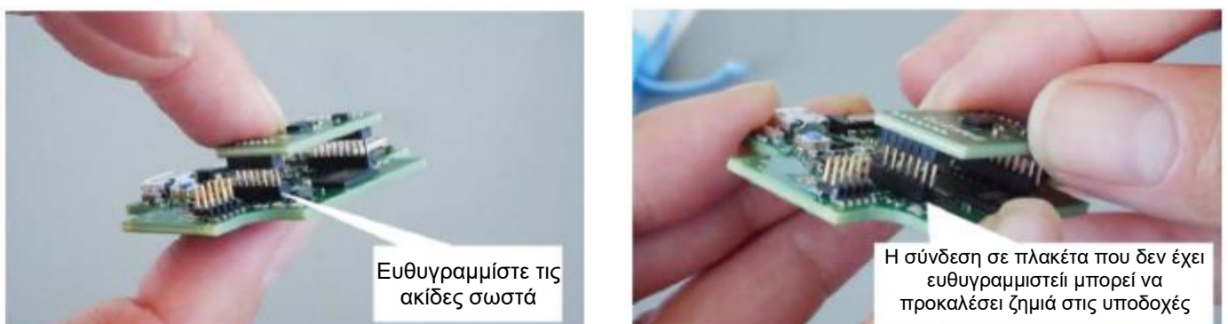
Αριθμός 8: Ευθυγράμμιση των ακίδων του Shuttle Board 3.0
