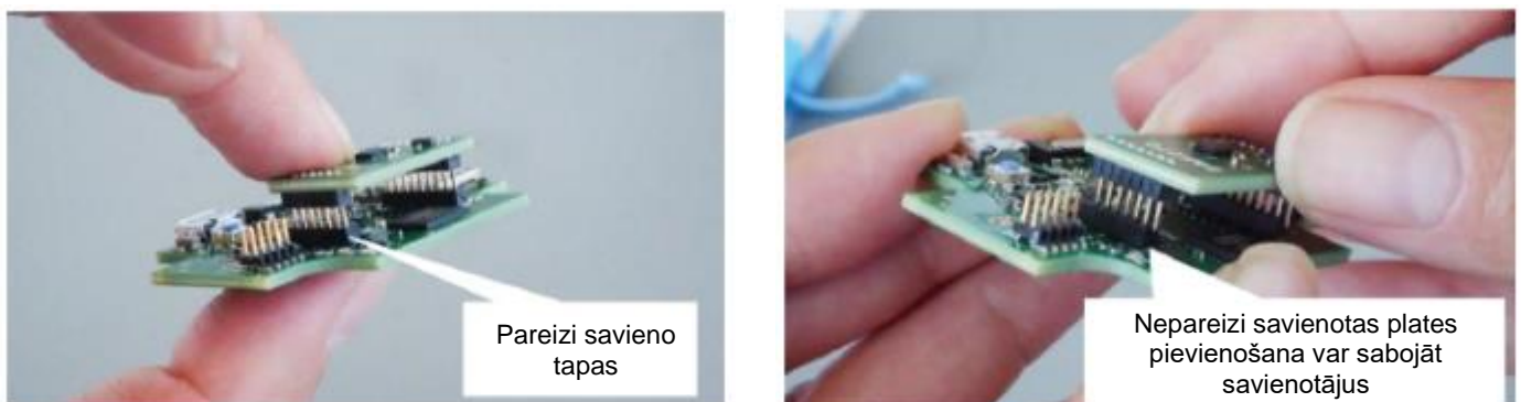
Attēls 8: Shuttle plates 3.0 tapu savienošana
