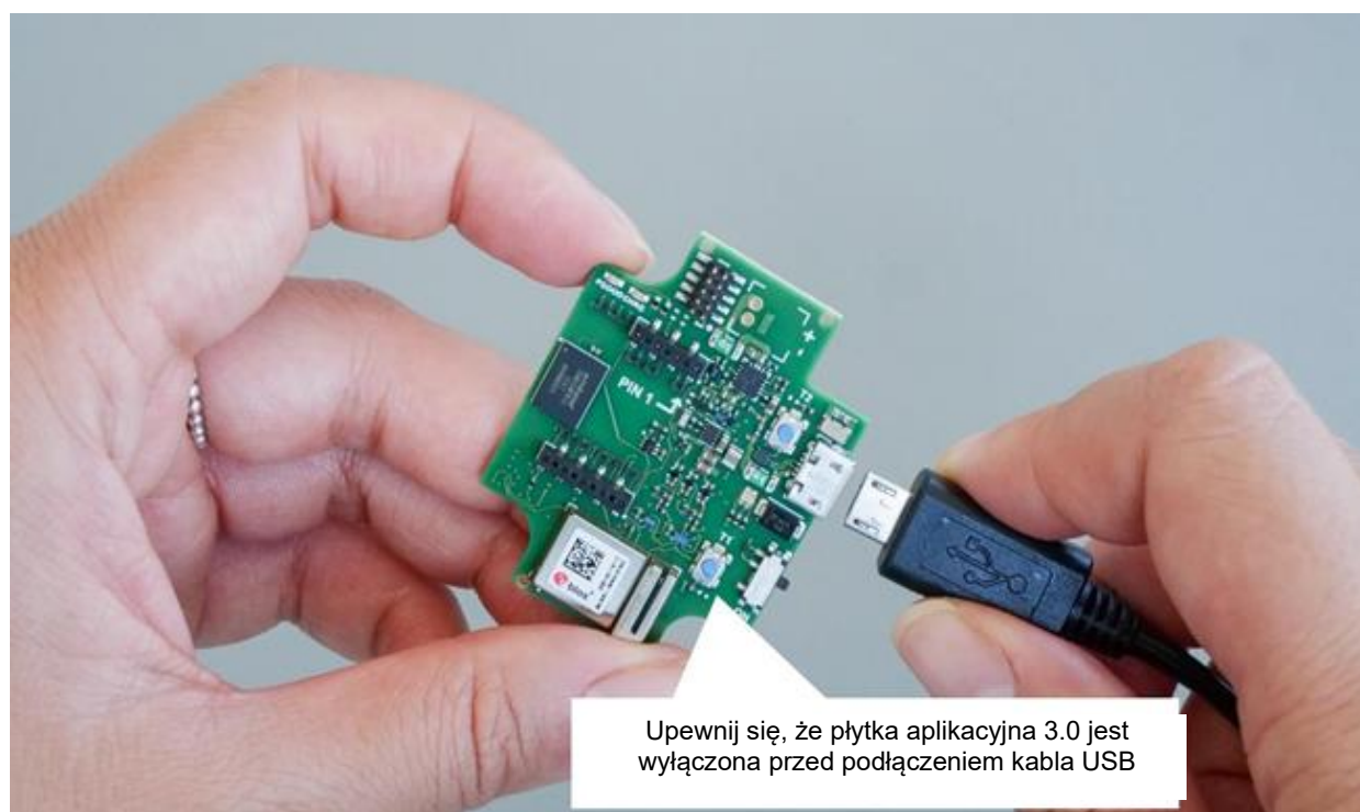
Ilustracja 10: Podłączanie kabla USB
