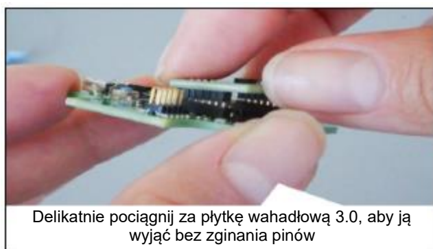
Ilustracja 12: Zdejmowanie płytki wahadłowej 3.0
