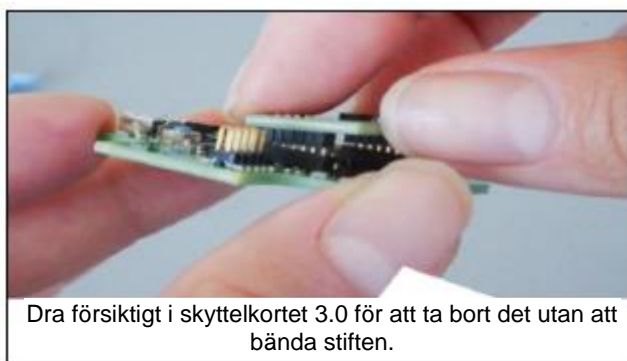
Figur 12: Ta bort skyttelkortet 3.0
