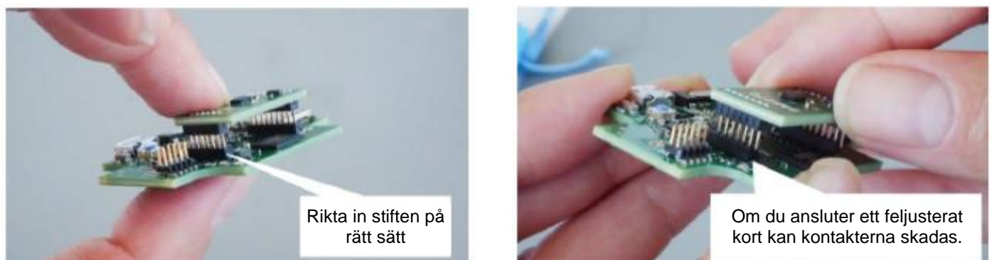
Figur 8: Justera stiftstiften på Shuttle Board 3.0-kortet
